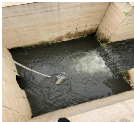
废水出口采样
