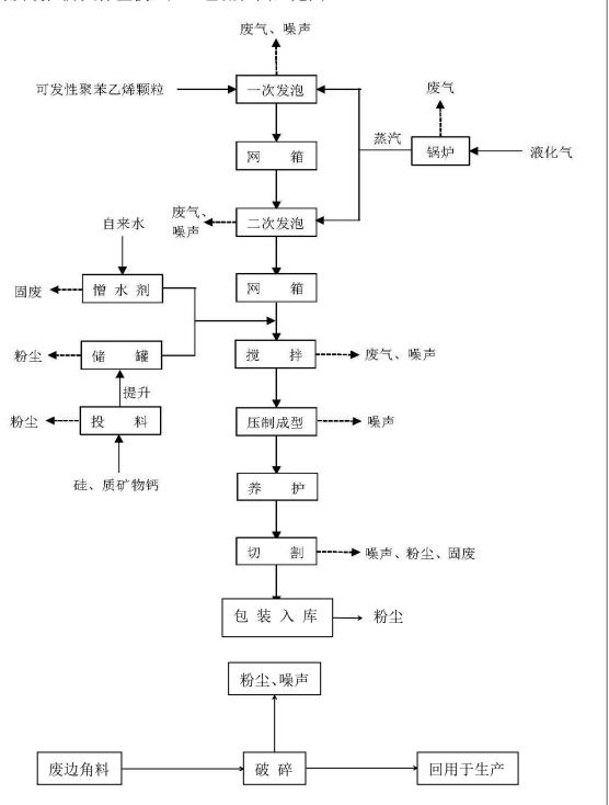
图 2-2 生产工艺流程及污染节点图
