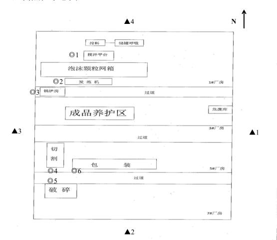
注: ▲厂界噪声监测点 ◎有组织废气监测点
